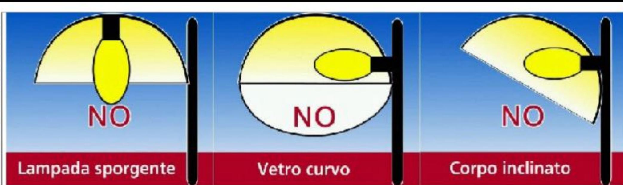
Figura 1 – Tipologie di apparecchi non ammessi dalla Lr17/09
